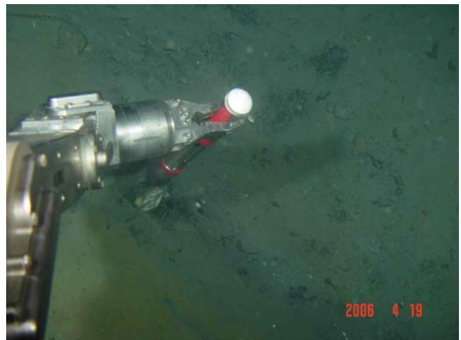
Figure 1 しんかい 6500 プッシュコアラーによるサンプリングの様子
